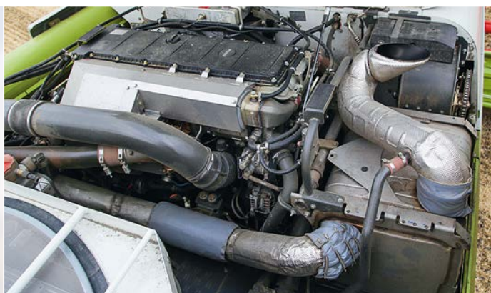
Kraftwerk: Der Mercedes-Benz OM 473 leistet bis zu 626 PS und erfüllt die Abgasstufe IV. Die Isolation vom Auspuff wurde verbessert, und zukünftig gibt es statt MTU-Logo auch einen Mercedes-Stern auf dem Ventildeckel.
