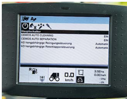
Die neue Rotorklappensteuerung und auch die Cemos Automatik ist jetzt im Cebis-Bildschirm an der Armlehne integriert.
